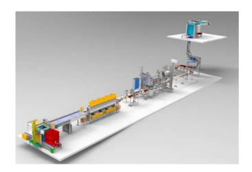
Nous concevons et fabriquons en France l'ensemble des éléments de transitique nécessaires à votre projet. Sur la partie production, nous intégrons les éléments de dosage et de sertissage en fonction de vos besoins. Dans votre magasin nous pouvons intégrer tous types d'éléments de contrôle et de suremballage, mais également automatiser la gestion de vos cartons et palettes.
